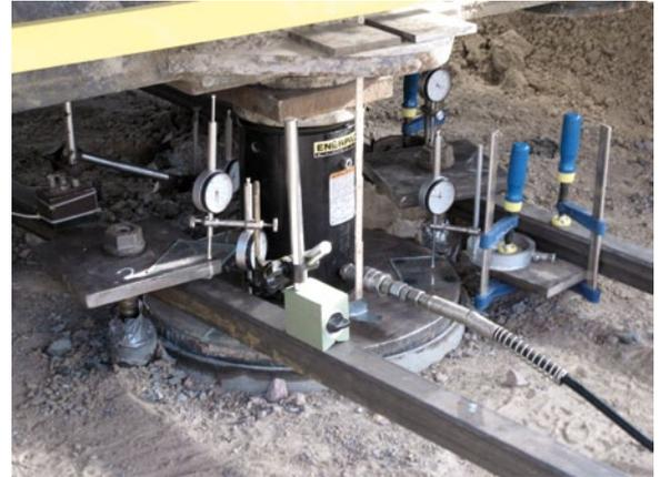
Druckzylinder und Wegaufnehmer bei einer typischen Probelastung
